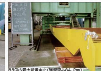
新型桁サポート (荷重450kN時)
